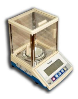
Весы лабораторные МЛ В1ЖА «Ньютон» (технологические) предназначены для определения массы любого материала с повышенной точностью.
